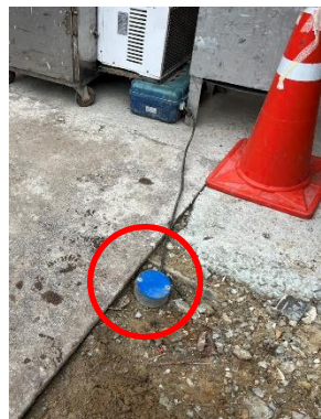
รูปที่ 3.17 การตรวจวัดความสั่นสะเทือน บริเวณพื้นที่โครงการ
